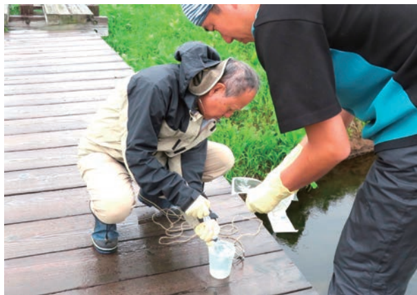
採水して注射筒に吸い込む作業
